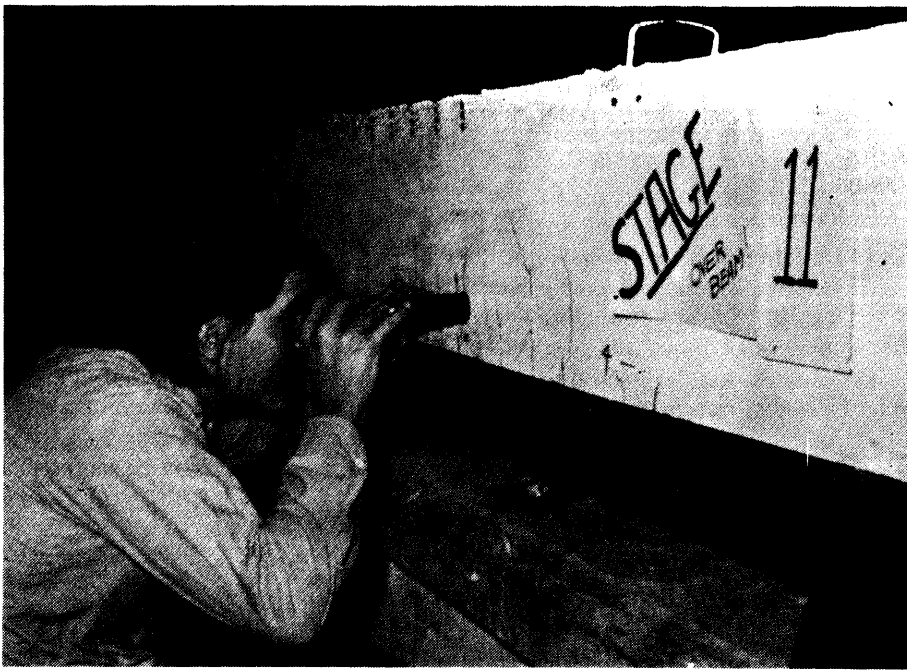
Foto 37 Balok ditumpu sederhana sesaat sebelum taraf beban retak tarik diagonal. (Tes oleh Nawy dkk.)
